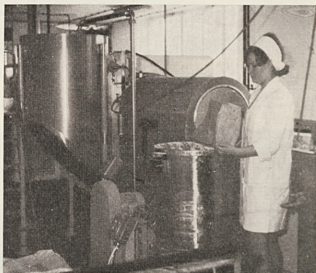
Strojno mešanje surovin v mešalcu za testo
