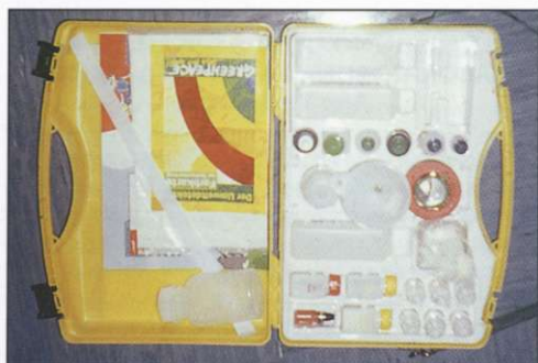
Prenosni laboratorij – koveček za delo na terenu (foto: A. Vovk Korže).
