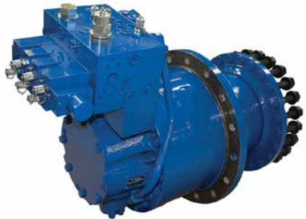
Poclainova pogonska naprava za ladijski vitel – hidravlični motor prostornine 15 l/obrat je izdelan v francoski tovarni, upravljalni ventilski blok in celovita rešitev pa v tovarni v Žireh.
