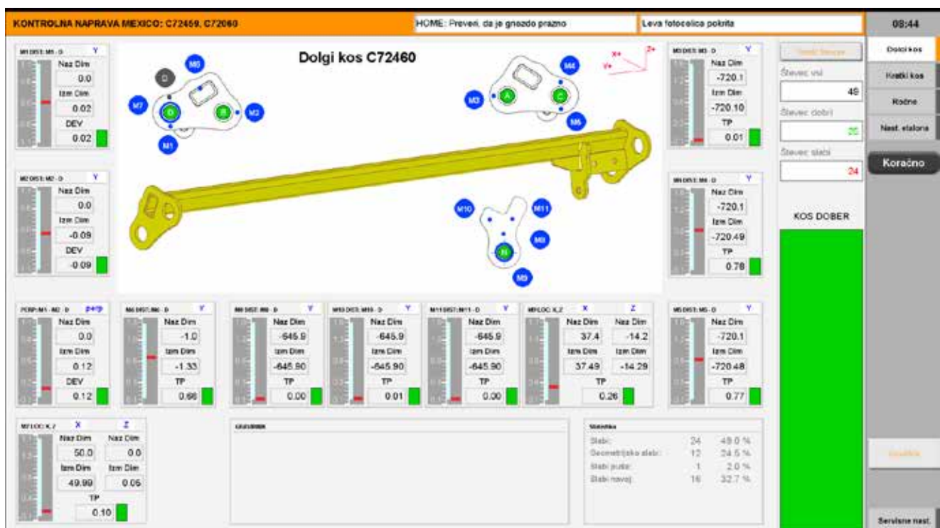
Slika 2: Prikaz zvarjenca z rezultati meritev
