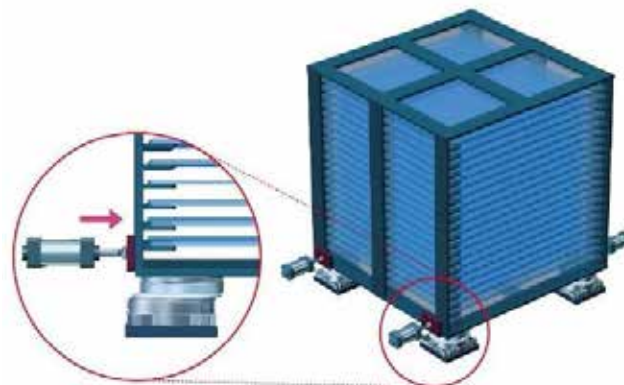
Slika 2 : Postavitev centrirne enote v transportno linijo
