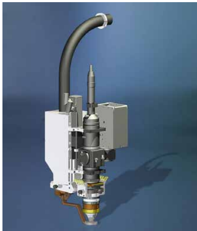
Slika 1 : Laserska glava za navarjanje z žico v kateri se žica ogreje preden se raztali z laserskim žarkom
