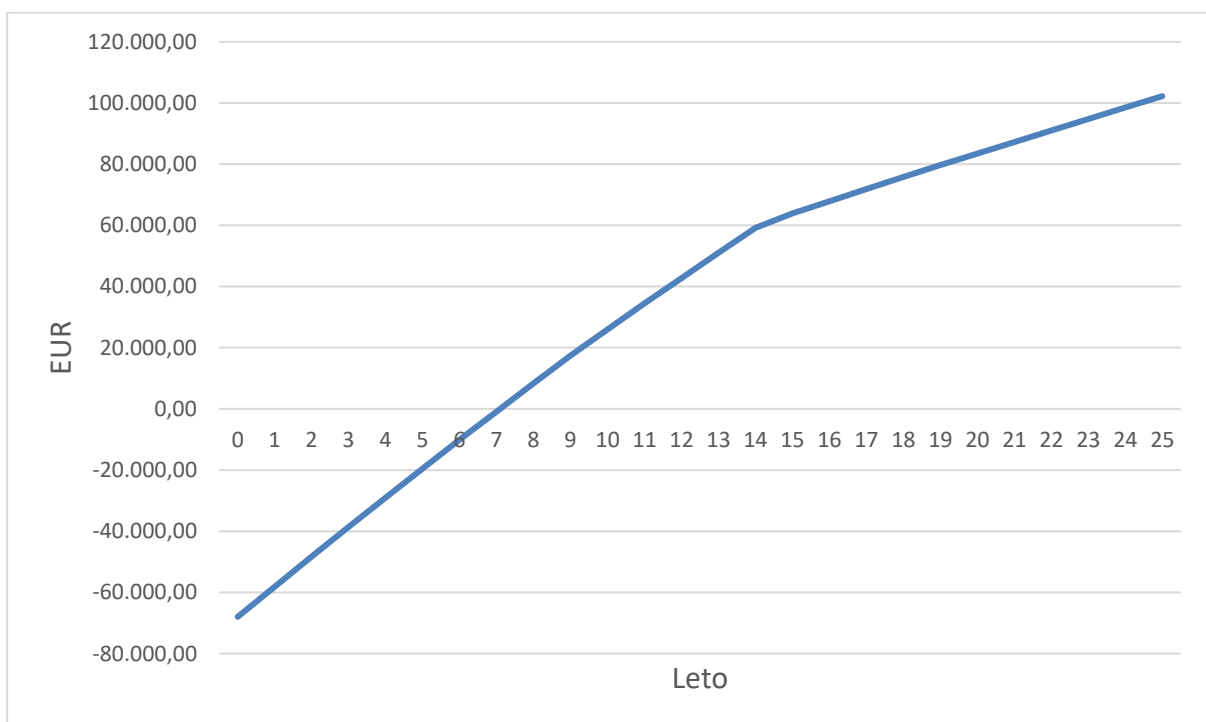
Slika 1: Kumulativni neto donos fotonapetostne elektrarne in doba vračanja investicije
