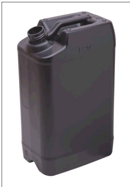
Slika 2: 20-litrska ročka s površinsko upornostjo, manjšo od 10^6 ohmov
