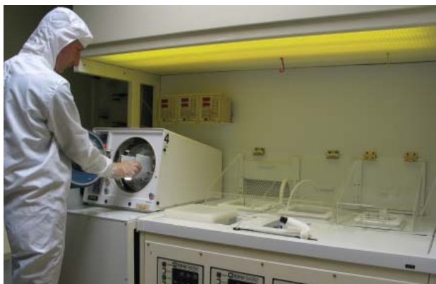
Čiščenje substratov v Laboratoriju za mikrosenzorske strukture in elektroniko
