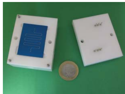
Mikrofluidni čip z ohišjem, razvit in izdelan v LMSE
