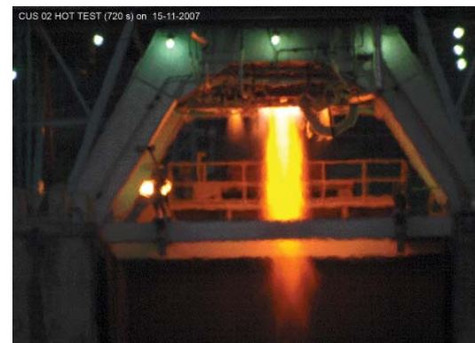
15. novembra 2007 je organizaciji ISRO uspel pomemben tehnološki mejnik, saj je uspešno preizkusila doma razvito kriogenično raketno stopnjo. Preizkus je bil izveden za polno delovanje ali 720 sekund pri enoti za preizkušanje tekočih pogonov v Mahandragiriju v Tami Naduju. (foto: ISRO)
