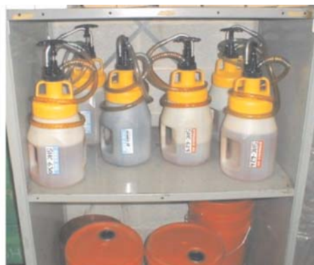
Slika 5: Izrazit primer neprimerne posode za razdeljevanje (levo) in primerno čista ter označena posoda za delo z mazivi (desno)
