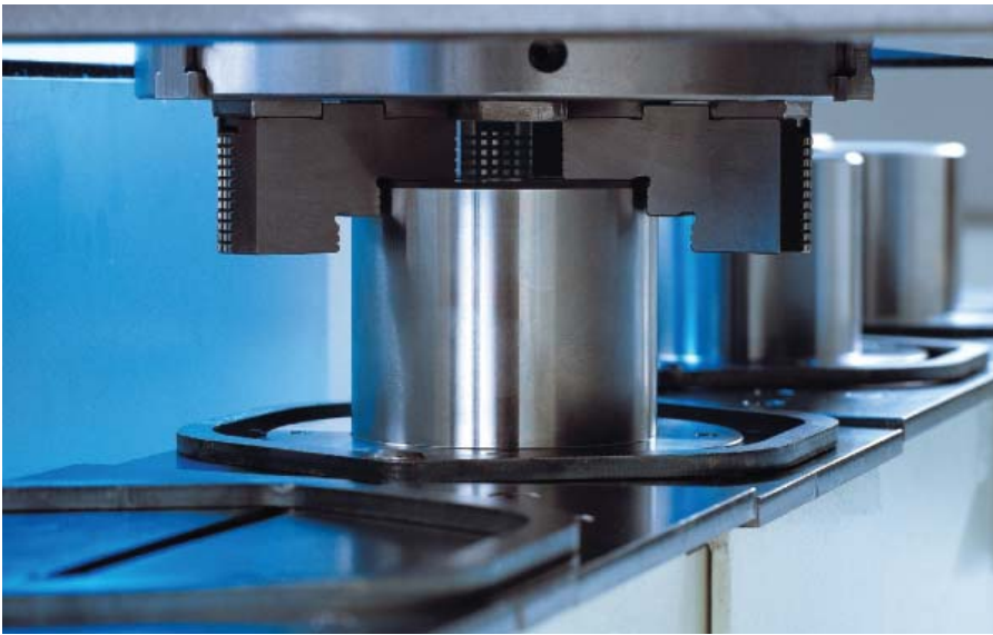
V posebni enoti se obdelovanci na osnovi NC-programa prenesejo s tekočega traku na posebno ogrodje, tako da so pozicionirani natanko na sredini. Kardansko delujoča pritiska plošča potisne obdelovanec v vpenjalne čeljusti in napravo za vpenjanje. Foto: Emag, Salach
