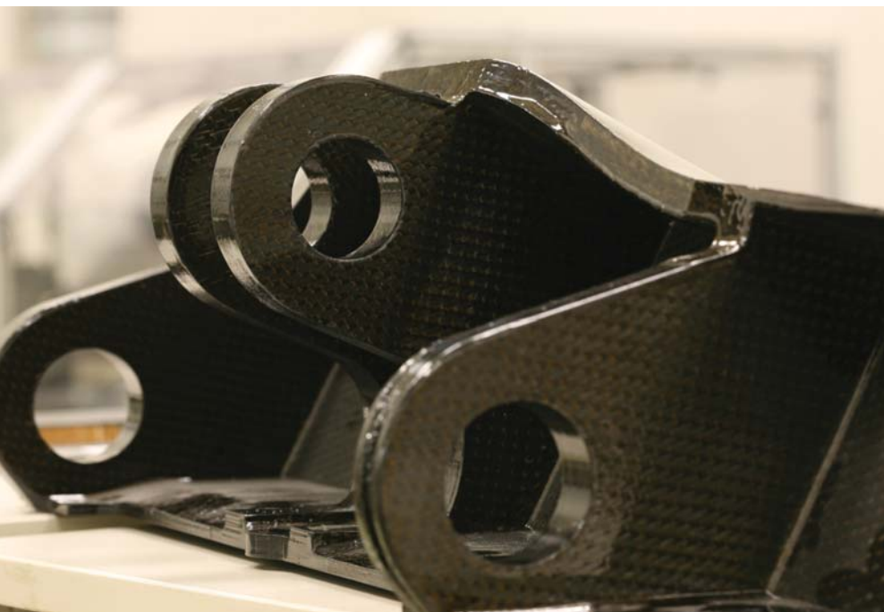
Fotografija prikazuje del letala, ki je kompletno narejen iz kompozitov. Uporaba kompozitov omogoča proizvodnjo tega specifičnega dela letala z minimalno količino odpadkov. To je zato, ker lahko ta del stopimo v točno željeno obliko v nasprotju z izdelavo podobnega dela iz aluminijaste snovi, ki bi jo morali izrezati iz celega bloka.
