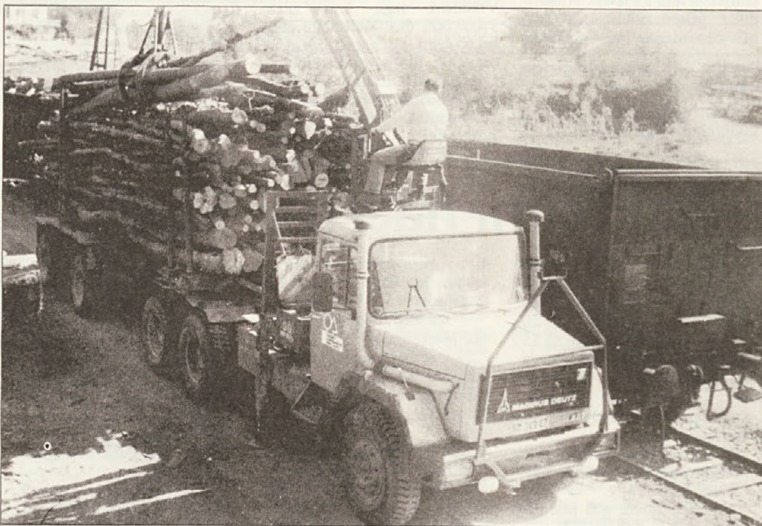
Proizvodnja goli (dolgi, droben obli les listavcev) je racionalizacija pri pridobivanju lesa, zlasti še, če je možno urediti transport tako kot je videti na sliki — iz kamiona takoj v vagon. Slika je iz odpremnega skladišča v Straži. S primerno dolgim lesom glede na možnosti spravila skušamo doseči zadovoljivo izkoriščenost sestave (kamion + polprikolica), ki je sicer pri takem transportu nekoliko manjša. Leta 1979 smo na GG izdelali 12.860 m 3 , leta 1978 pa le 3.968 m 3 goli. (Foto in tekst J. Kure, dipl. ing.)
