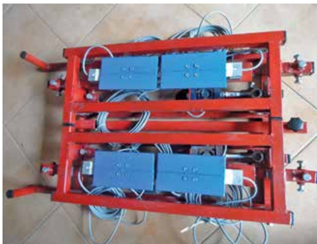
Slika 5: Merilna tenziometrijska naprava za ugotavljanje strukture odzivne moči smučarjev skakalcev
