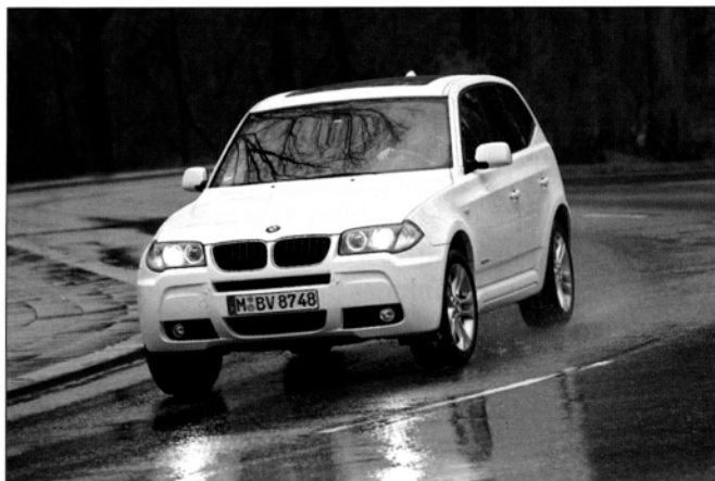
Štirikolesni pogon z elektronskim nadzorom zagotavlja variabilno porazdelitev pogonske sile med prednjo in zadnjo os oziroma na tista kolesa, kjer se lahko najučinkoviteje prenese na podlago (foto: BMW)
