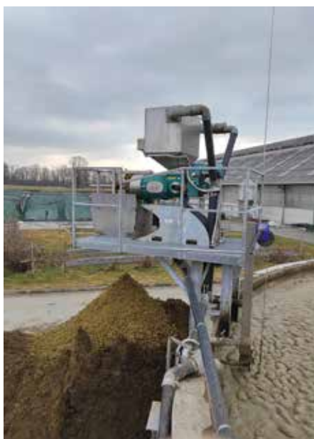
Z zagonom separatorja ob polni skladiščni jami lahko pridobimo prostor za črpanje gnojevke iz kanalov hleva. Takšna rešitev lahko pripomore k zmanjšanju potrebe po gradnji novega skladišča za gnojevko.
