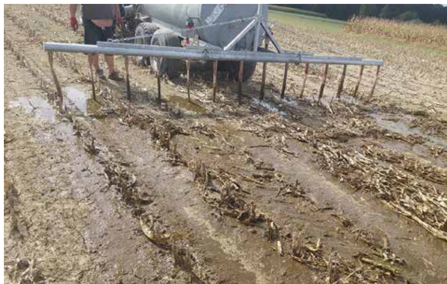
Enostavna doma izdelana konstrukcija za razdeljevanje gnojevke preko cevi.
