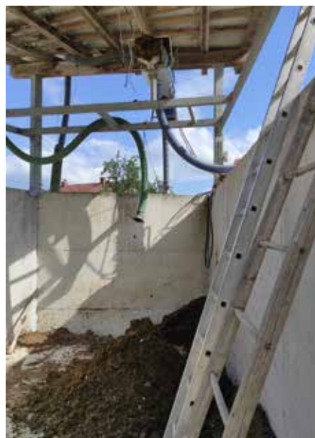
S skladiščenjem trdnega dela separata pod nadstreškom ali v zaprtem prostoru preprečimo, da se trden del zmoči zaradi dežja, s čimer ohranimo večjo vsebnost sušine v separatu.
