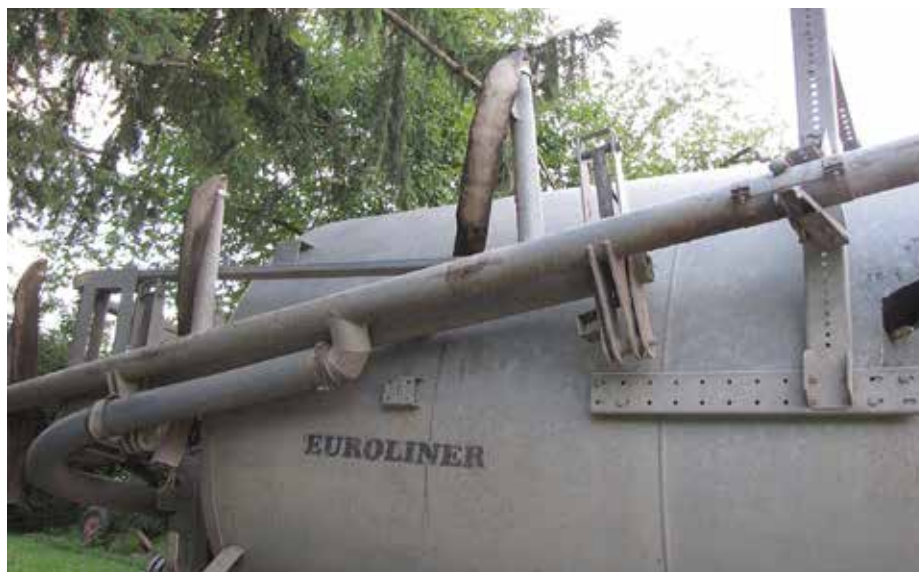
Cisterna Joskin Euroliner 24000 TRS, ki ima »doma« izdelane vlečne cevi za porazdeljevanje gnojevke. Po začetni uporabi so ugotovili, da je razmak med cevmi prevelik. Težavo so premostili z naknadno vgradnjo dodatnih vmesnih cevi.
