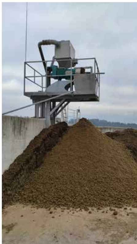
Skladiščna jama za gnojevko, separator in dva kupa trdnega dela separirane gnojevke različnih starosti.
