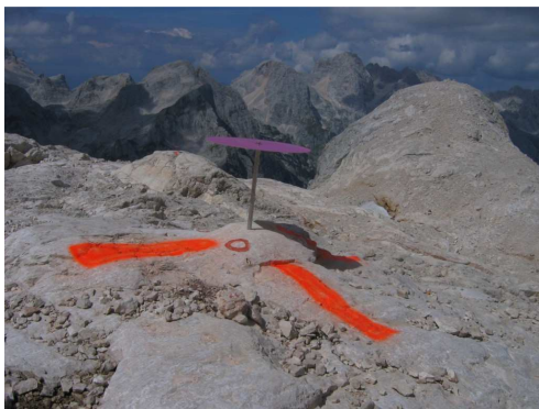
Slika 4: Stabilizirana oslonilna točka iz leta 2001, posneta ob fotogrametričnem snemanju 2003 (foto: Miha Pavšek)
