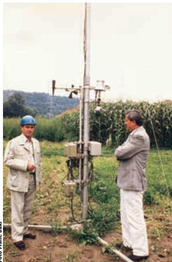
Terenska meteorološka postaja, vgrajena v stikališčnem platoju RTP Podlog za potrebe monitoringa termične obremenljivosti prenosnega sistema Eles.
