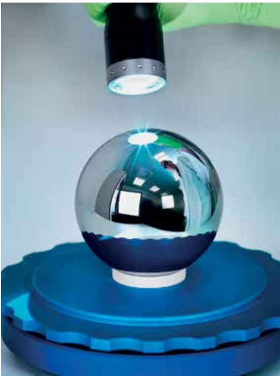
Slika 1: Krogla iz čistega silicija, ki je ta hip najbolj okrogel predmet na Zemlji. Težka je en kilogram, iz njene sestave in mer pa je mogoče določiti njeno težo s podobno negotovostjo, kot to lahko dosežemo s Kibblovo tehtnico. (Vir: Physikalisch-Technische Bundesanstalt, PTB)
