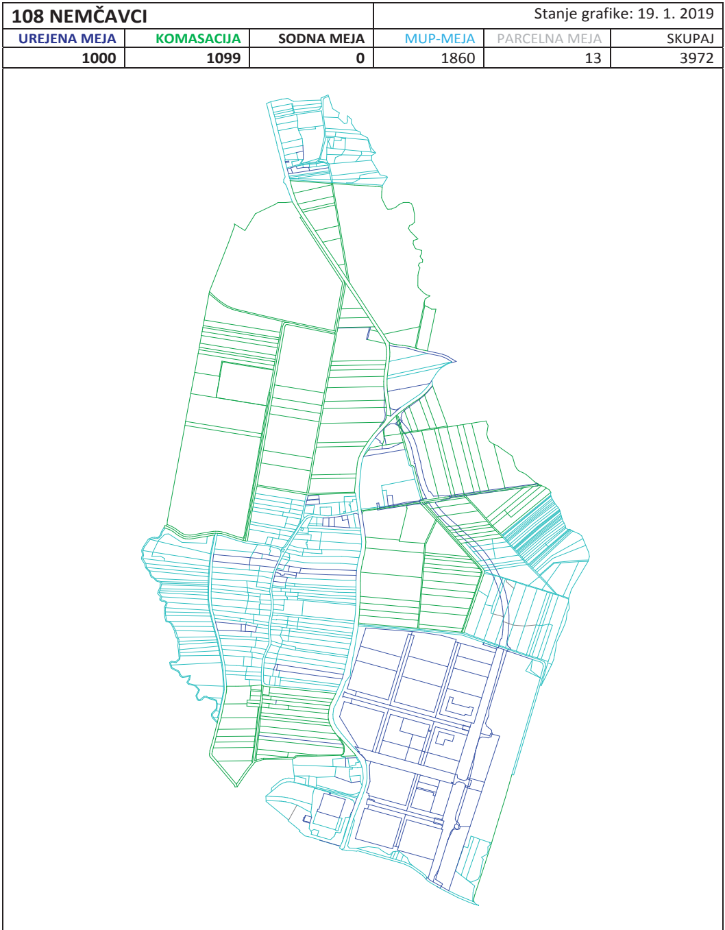
Slika 7: Primer kombinacije več vrst izmer v k. o. 108 Nemčavci. V 90. letih je bila izvedena nova izmera (svetlo modro) in komasacija kmetijskih zemljišč (zeleno, odebeljeno). Urejene meje iz geodetskih postopkov po letu 2000 so vidne v odebeljeni temnomodri barvi – izstopa urejeno območje OPPN Severne obrtno-industrijske cone (SOIC) z vzhodnim delom obvoznice Murske Sobotice. Vir: OGU Murska Sobota, 2019.
