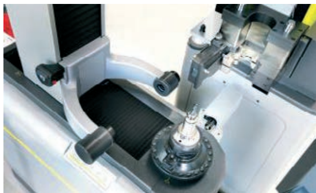
» Rešitev za vse uporabnike vpenjalnega sistema powRgrip® za vpenjanje orodja na določeno dolžino – naprava "venturion 600" z vpenjalnim sistemom powRgrip.
