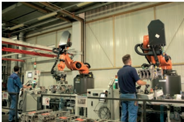
» Dva na podstavku nameščena roboti KUKA tipa KR 210 R2900 prime iz serije KR QUANTEC omogočata optimalno kontrolo ohišij ročičnih gredi v tovarni BMW v Landshutu v Nemčiji.
