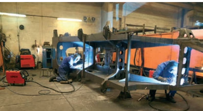
» Tehnologija SpeedPulse XT najbolj pohitri varjenje jekla. (foto: x-technik)
