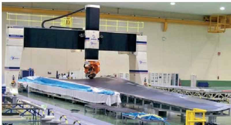
» Stroj za nanašanje trakov vlaken potuje po celotni dolžini in širini kalupa.
