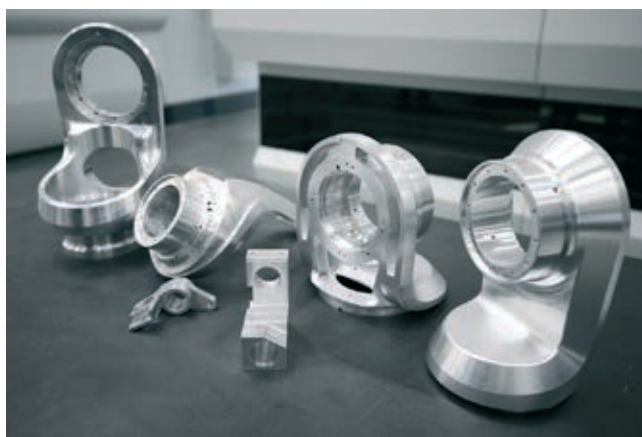
» Deli robota različnih velikosti, ki so bili v celoti izdelani na dvanajstih novih CNC-obdelovalnih centrih C 42 UP proizvajalca HERMLE.
