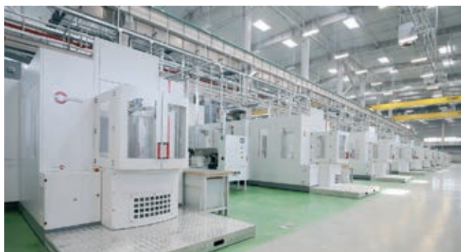
» Tako imenovana cesta Hermle v podjetju STMC z dvanajstimi novimi visoko zmogljivimi 5-osnimi obdelovalnimi centri C 42 UP s paletnimi izmenjevalniki.
