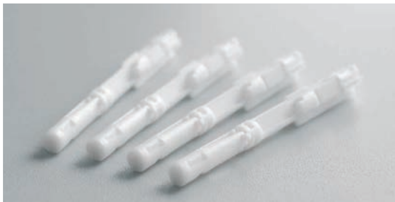
» Zahtevna držala lancet, brizgana v orodju s štirimi gnezdi, so izdelana iz teflonsko modificiranega polioksimetilena (POM).
