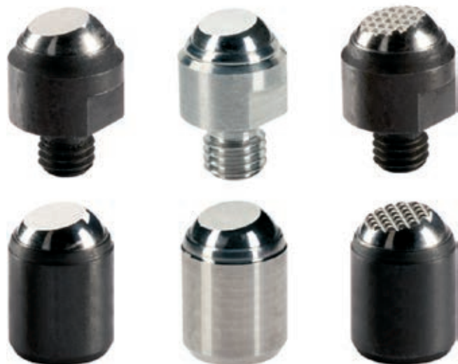
» Slika 1: Samopovratni nihajni nasloni so lako s s tolerančno moro za vtiskovanje in z zunanjim navojem. Narebne naslonske površine se dobro obnesejo pri grobih obdelavah, z ravnimi površinami pa pri finih obdelavah.
