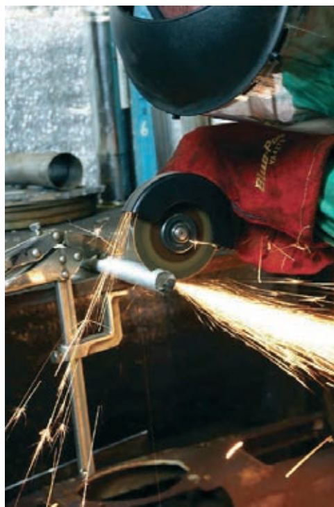
» Slika 1: Pravilna odločitev za izbiro rezalne plošče je odvisna od vrste materiala, ki ga režemo.
