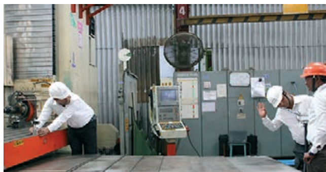
» Priprava testa z napravo QC20-W ballbar v Godrejevi tovarni
