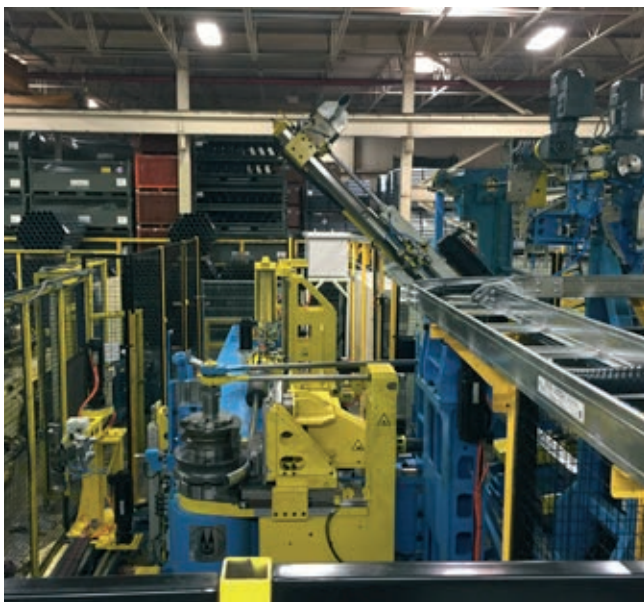
» Dodajanje materiala v CNC 100 E TB MR VA: Nihajni strežni sistem, razvit pri Schwarze-Robitec, samodejno streže stroj za krivljenje z vhodnim materialom.
