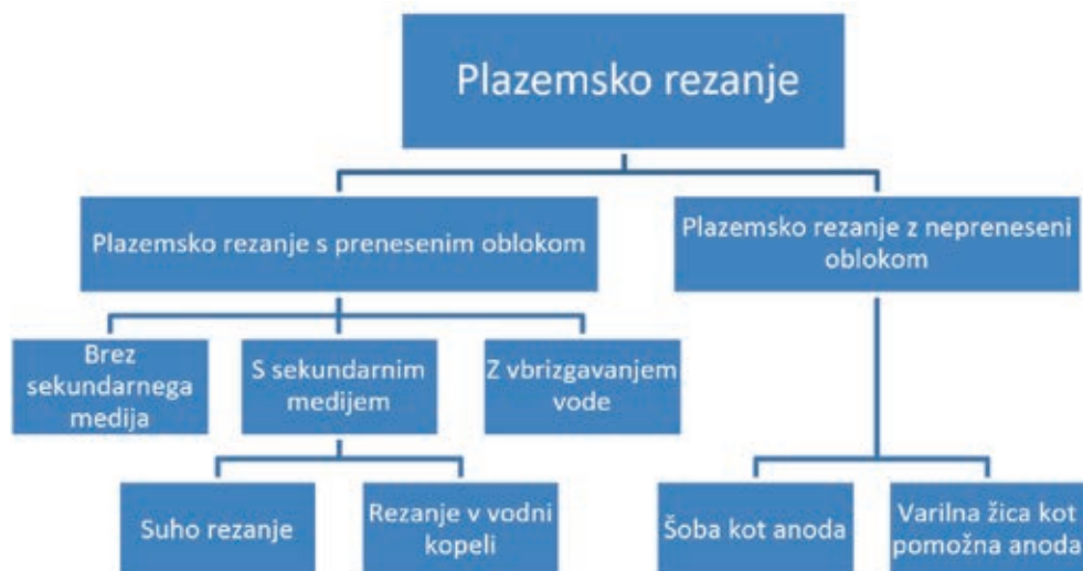
» Slika 2: Postopki plazemskega rezanja
