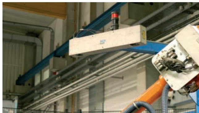
» SICK ScanningRuler zagotavlja natančne in zanesljive 3D-meritve nepremičnih objektov – idealno za uporabo v aplikacijah prijemanja in pobiranja z robotom.
