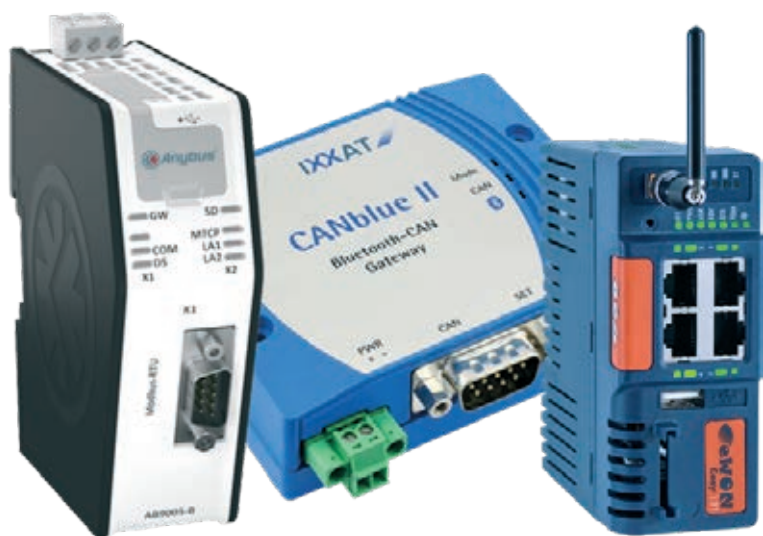
» Slika 2.: Podjetje HMS Industrial Networks svoje produkte deli v tri blagovne znamke – Anybus vmesniki so namenjeni komuniciranju med različnimi »Fieldbus« področnimi vodili in industrijskimi Ethernet protokoli, IXXAT moduli so namenjeni komunikacijskim rešitvam na področju CAN-omrežij in »Safety« funkcionalnosti, blagovna znamka eWon pa pokriva komunikacijsko opremo za oddaljen dostop do strojev in naprav.
