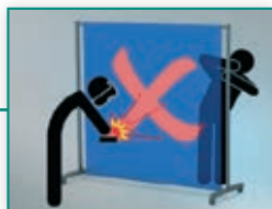
142 Skrite nevarnosti zaščitnih transparentnih zavese pri varjenju
