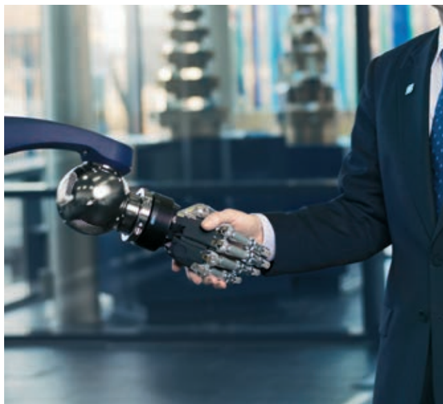
» Petprstna roka SCHUNK SVH je prvo prijemalo na svetu s certifikatom DGUV za delo skupaj s človekom.
