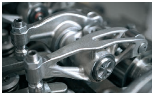
» Modificirana verzija odmične nihalkе ventilov, ki je izdelana s tehnologijo dodajanja materiala po plasteh, med izvajanjem laboratorijskih testov.
