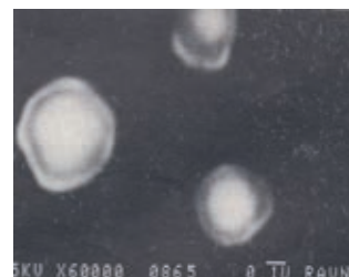
» Slika 11: Prašni delci iz zračne atmosfere v jeklarni, pov. 60 000x, sekundarni elektroni.
