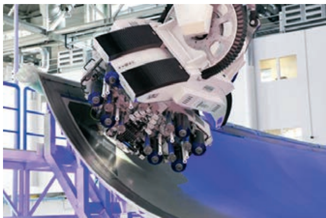
» Glava za avtomatski nanos vlaken M-Torres, ki jo pri Airbusu uporabljajo za nanos kompozitnega traku na kalup kril letala A350.
