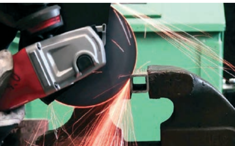
» Slika 3: Vsebina zrn predstavlja kakovost in uporabnost rezalne plošče.
