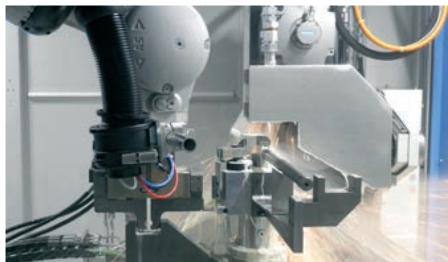
» Robot KUKA vodi obdelovanca natančno vzdolž rezalne orodja.
