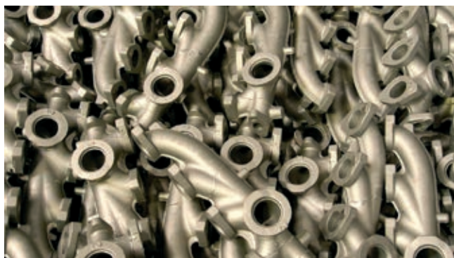
» Naključno postavljeni kovinski deli v zaboju – pobiranje na hiter in zanesljiv način je naloga sistema SICK PLB.
