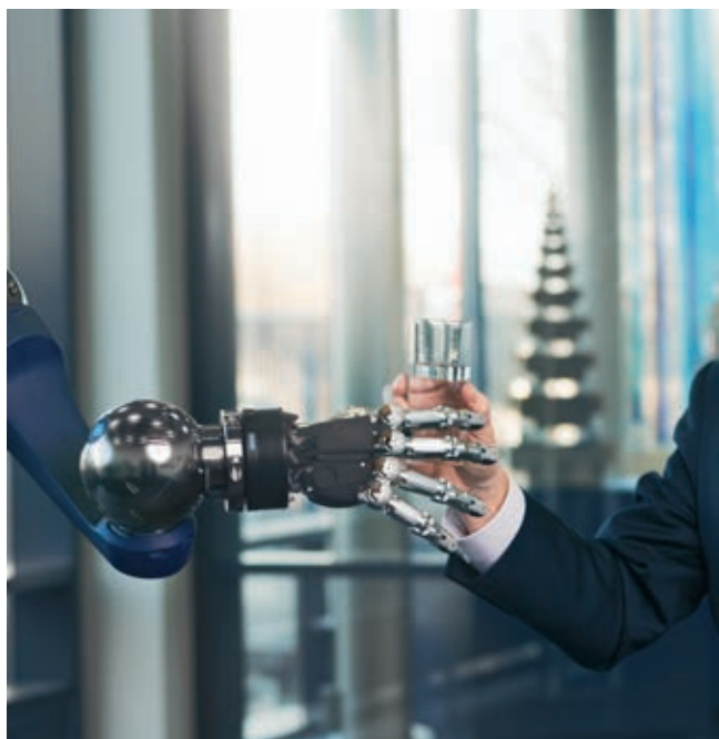
» Petprstna prijemalna roka SCHUNK SVH odpira nove možnosti pri sodelovanju človeka in robota v asistenčni in servisni robotiki.
