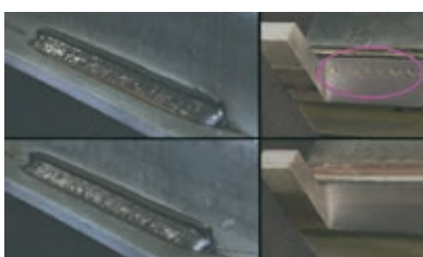
WELBEE WAVE PULSE način zmanjša poroznost zaradi cinkovih par.
