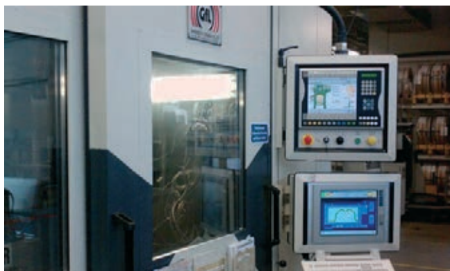
» Slika 1: Procesni nadzorni sistem Brankamp Marposs dograjen na preoblikovalni stroj – spodnji ekran
