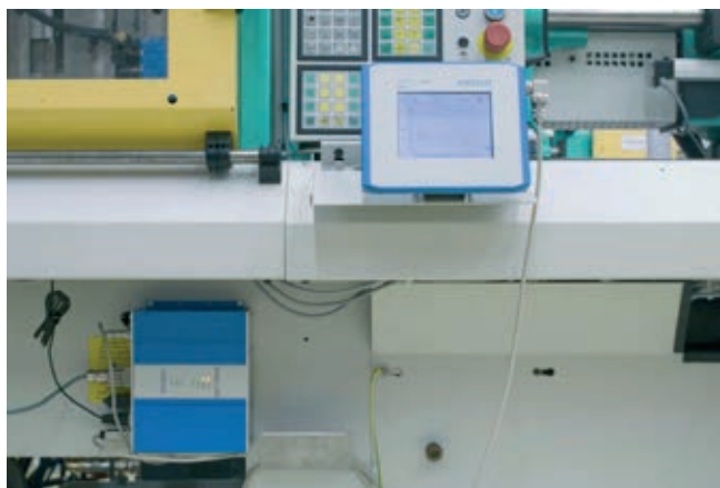
» Sistem za spremljanje procesa brizganja CoMo Injection z zaslonom (na desni poleg upravljalne plošče stroja) skrbi za avtomatsko izločanje slabih kosov.
