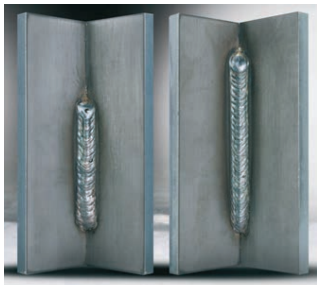
» Vertikalno varjenje že od nekdaj velja za najtežje. Popoln vertikalni zvar je nagrada za vsakega varilca, tehnika je zahtevala počasno in natančno delo, obvladali so jo le specialisti – vsak večji pritisk je namreč pomenil »avtogol«. (foto: Lorch)
