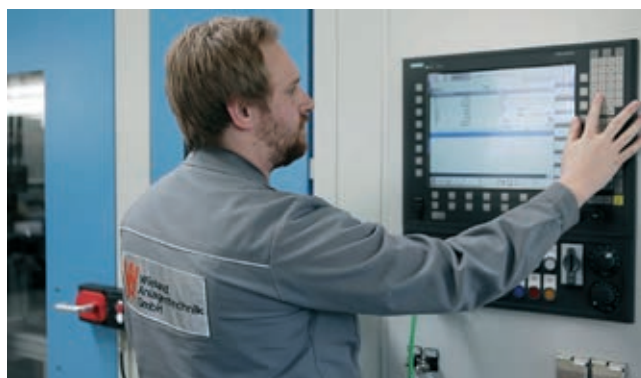
» Enostaven nadzor s krmilnikom Run MyRobot. Robota KUKA se lahko nadzira s Siemensovim krmilnikom ali s ročno konzolo Siemens HT8.
