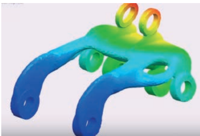
» Slika 7: Analiza korigirane topologije
