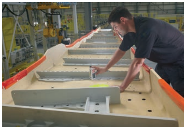
» Preverjanje kalupa za izdelavo kompozitnega dela letalskega krila kompleksne oblike.
