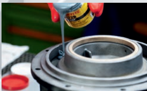
Popravilo kovinskih površin
