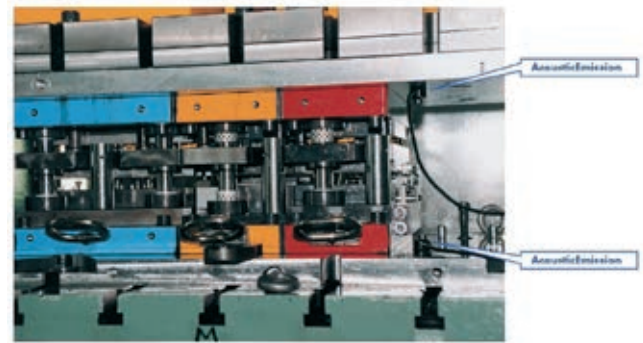
» Slika 4: Brankampovi akustični senzori za detekcijo loma trnov in pokanja orodij
