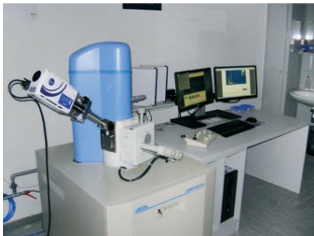
» Slika 1: Vrstični elektronski mikroskop JEOL JSM 6510 in EDS mikroanalizni sistem Oxford Instruments [3]
