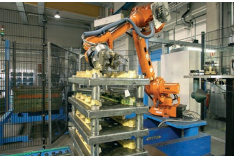
» Sistem PLB vodi robota tudi v primeru odlaganja in pobiranja iz transportnih vozičkov.
