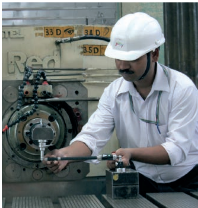
» Priprava testa z napravo QC20-W ballbar v Godrejevi tovarni
