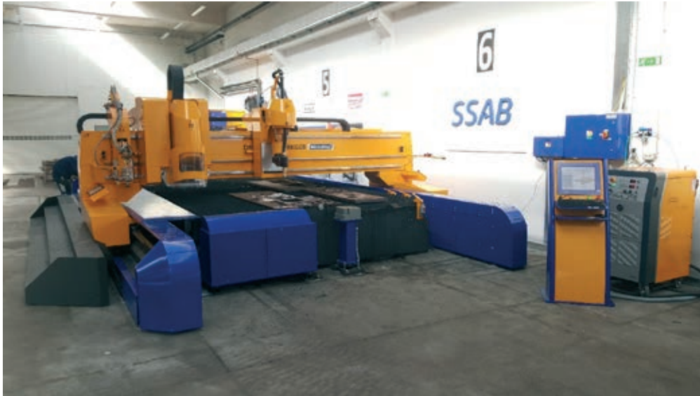
» Slika 1: Microstep DRM CNC-rezalnik, opremljen s Kjellberg HiFocus 360i plazemskim izvorom in dodatnimi orodji za druge postopke obdelave pločevine
