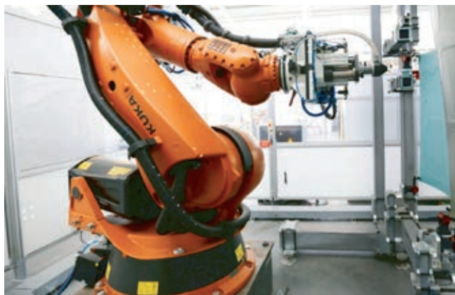
» Robotski stroj za grezenje razvit v raziskovalnem centru.
