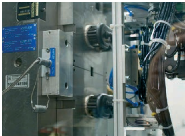
» Večkanalni vtič na zunanji strani orodja združi vse signale v enem kablu in jih poveže s sistemom CoMo Injection
