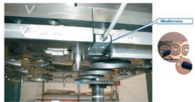
» Slika 5: Brankampov ultra emisijski senzor za detekcijo delcev padlih v orodje za zaščito izdelkov
