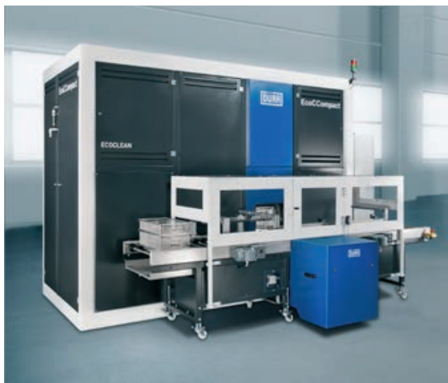
» V celoti vakuumsko naprava EcoCCompact lahko deluje z nehalogeniranimi ogljikovodiki ali modificiranimi alkoholi (polarnimi topili) in jo je mogoče preprosto predelati z delovanja na eno topilo na delovanje na drugo topilo.
