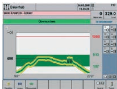
» Slika 8: Nadzor preoblikovalnega procesa (sile) z dvojno ovojnico (opozorilna in ustavljajna) okrog izmerjene črne krivulje, mejami trenda (zeleno vodoravno polje) in maksimalno silo (rdeča črta)
