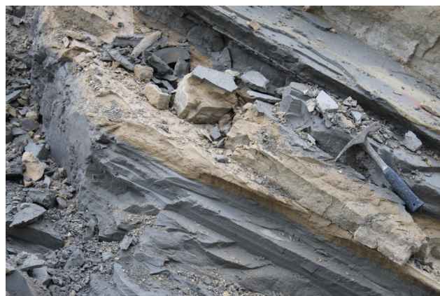
Sl. 4. Plastovit badenijski lapornati meljevc in peščenjak iz izkopa za HE Brežice.
