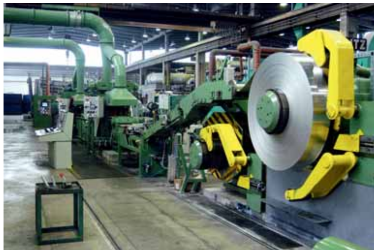
Linija za hladno valjan trak
