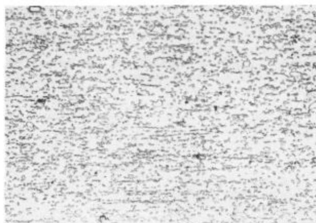
Slika 3 Struktura ledeburitnega jekla PK9 Povečava: 200 × Jedkalo: nital
