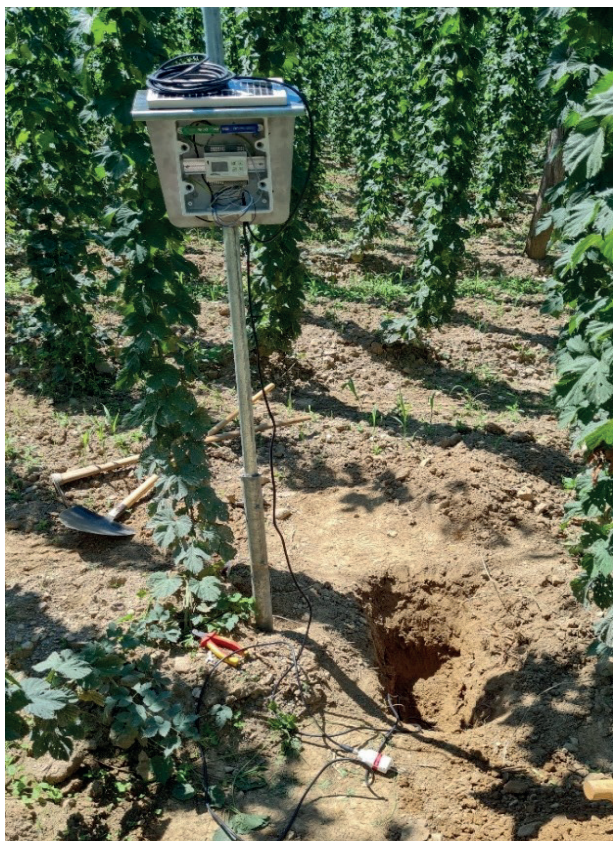
Data loggerji (beležniki podatkov) pošiljajo podatke o stanju vlažnosti tal, ki jih beležijo sonde, na splet. (Foto: B. Naglič)
