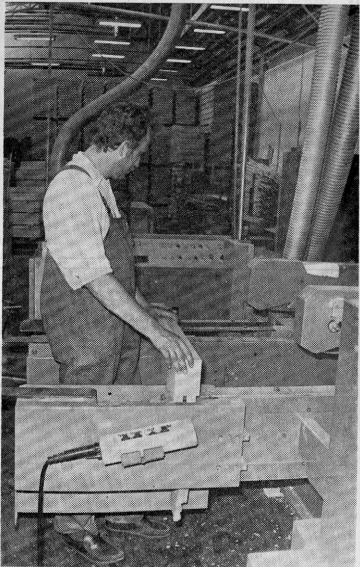
Oddelek B4 podbojev Rogljčenje podbojev na stroju Gabbiani
