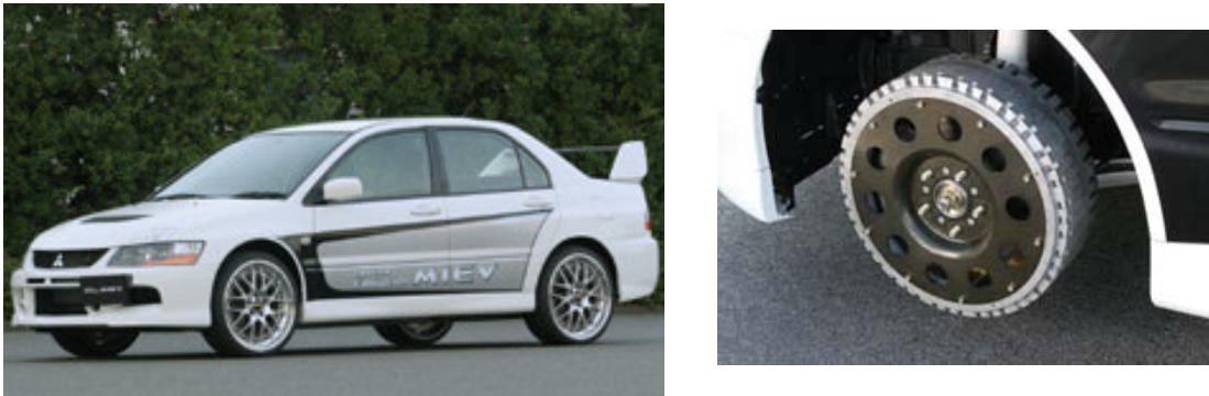
Slika 12: Mitsubishi in njegov in-wheel motor [A7]
