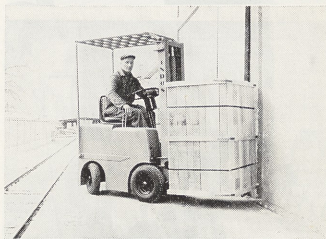
Nabavili smo dva nova akumulatorska viličarja, enega za sukalnico, drugega pa za interni transport.
