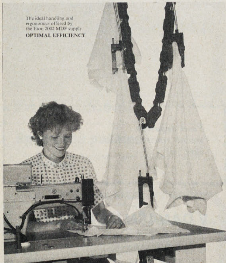
Sodoben viseči transport v proizvodnji.
