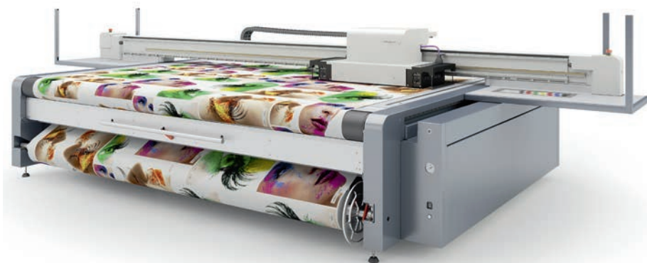
Sistem SwissQprint Nyala 2 omogoča tudi neskončni tisk iz zvitka v zvitek širine največ 3,2 metra.
