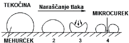
Implozija mehurčka na trdni površini in nastanek mikrocureka - KAVITACIJA
