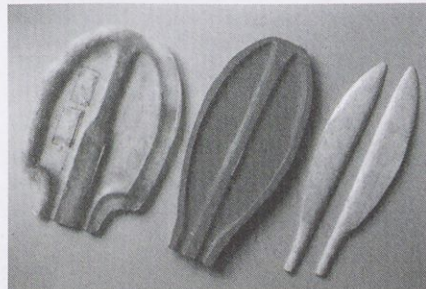
Modeli so običajno leseni, kalupi pa so lahko izdelani iz epoksidne ali poliestrske smole.
