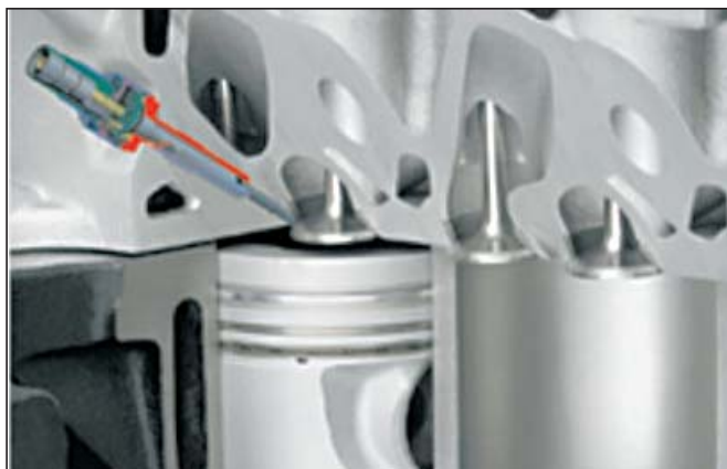
Namestitev senzorja v glavi dizelskega motorja
