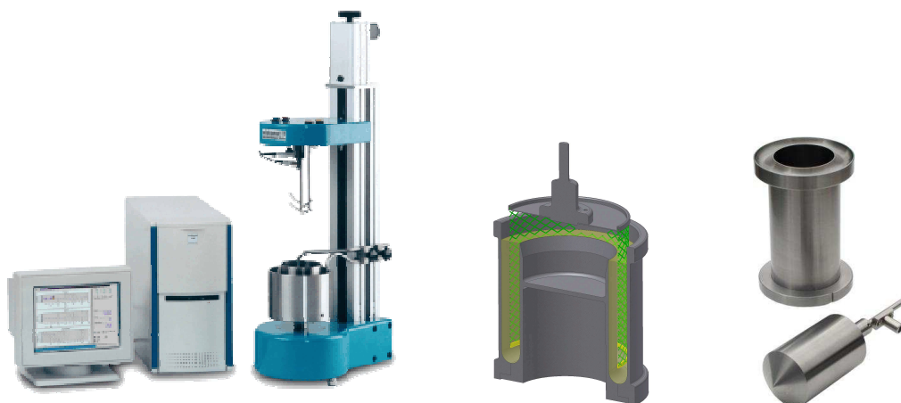
Slika 9: Schleibinger Viscomat NT (levo), nastavek v obliki košare (sredina), nastavek koaksialnih valjev (desno) (Schleibinger, 2013b).
