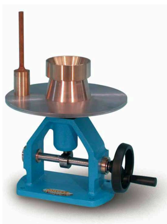
Slika 35: Oprema za preskus razleza malte ( http://www.matest.com ).
