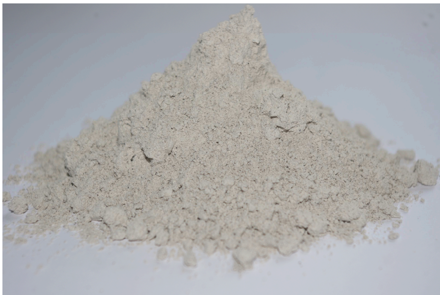
Slika 32: Kamena moka. Figure 32: Limestone filler.
