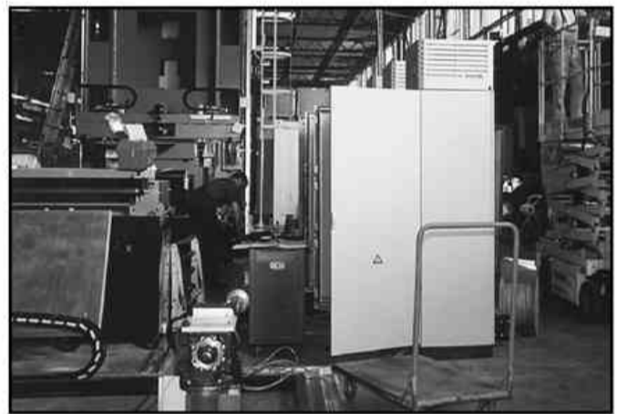
V programu Kuhalnih aparatov odstranjujejo opremo hladilno zamrzovalnih aparatov in nameščajo 1000 tonsko stiskalnico za izdelavo pločevinastih polizdelkov štedilnikov.
