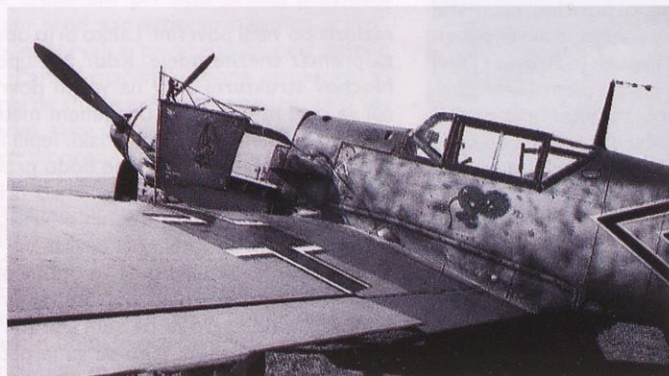
Lippertov Bf 109E v Grčiji. Lepo se vidi znak štaba II./JG 27 pod kabino in poševni oklep za pilotovo glavo brez zgornjega dela.
