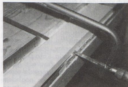
Slika 3. Žaganje trikotne letve
