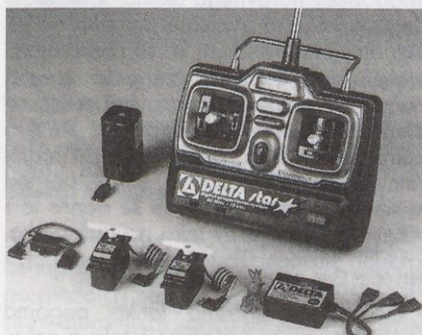
Slika 1. Multiplex delta je kakovosten AM-sistem za frekvenčni območji 27 in 40 Mhz.
