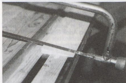
Slika 1. Princip izdelave: zgoraj se žaga nasloni na cev, spodaj na pločevino.
