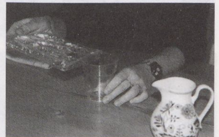
Slika 1. Količino potrebne vode izmerite s pomočjo kalupa.
