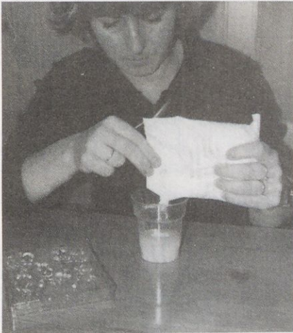
Slika 2. V vodo stresite strjevalno maso v prahu.
