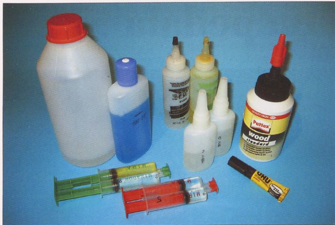
Na sliki so osnovna lepila, ki jih modelar potrebuje pri svojem delu. Zadaj z leve proti desni so: 24-urna epoksidna smola z modrim trdilcem za laminiranje in zahtevnejše lepljenje, 30-minutno epoksidno lepilo, srednje in redko tekoče sekundno lepilo ter belo disperzijsko polivinilacetatno lepilo. Spredaj ležijo (z leve): 30-minutno in 5-minutno epoksidno lepilo v brizgah, na desni pa je sekundno lepilo gel v tubi.
