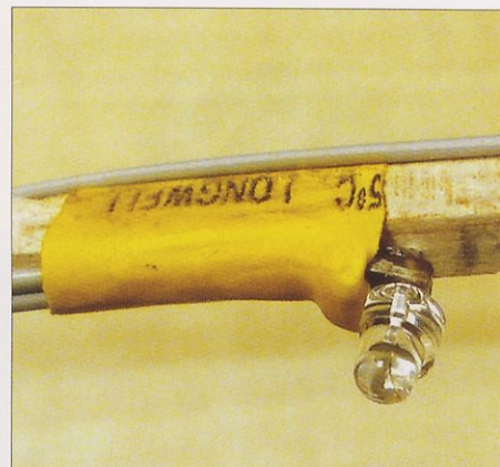
Pritrditev svetlobne diode (D2–D4) na letvico
