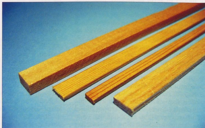
Največkrat uporabljeni materiali za letvice so (z leve proti desni): lipovina z zelo homogeno strukturo, druga in tretja sta smrekovi letvici (bodite pozorni na število in vzporednost letnic), zadnja pa je balzova z rezom B.
