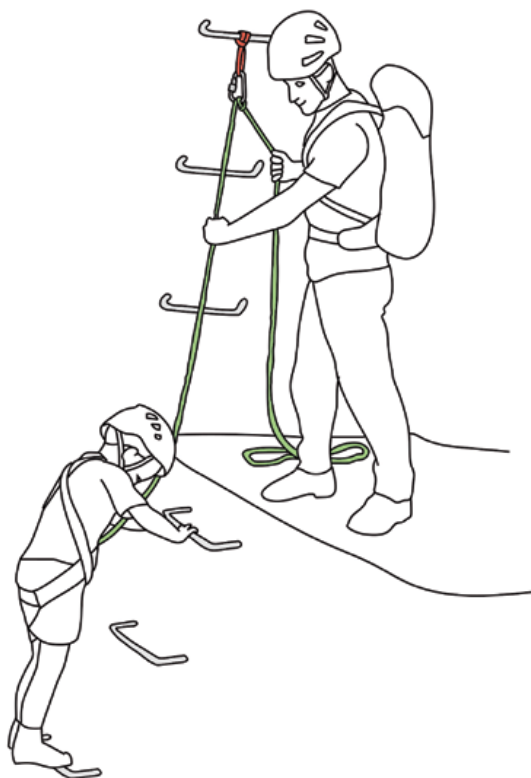
Varovanje s polbičevim vozlom na skobo Skica: Jernej Lukša
