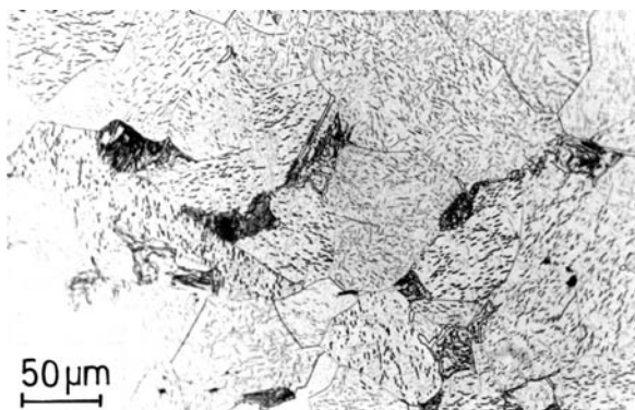
Fig. 27: Rod P 3702/1. Microstructure of the rod in a distance of 10 mm from the tip. Sl. 27: Ost P 3702/1. Mikrostruktura osti v oddaljenosti 10 mm od vrha.
