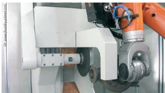
» Reichmannov robotiziran sistem za odstranjevanja dolivnega sistema na ulitkih.
