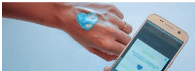
» Tiskana elektronika v službi zdravja: pametni obliži My UV Patch podjetja L'Oreal opozarja uporabnika na izpostavljenost sončnim žarkom.
