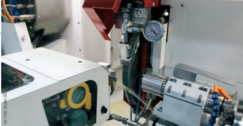
» STUDER S41 z integrirano enoto za ostrenje WireDress®.
