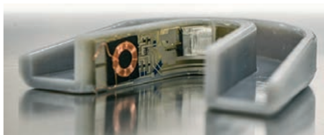
» Elektronski kontrolor zdravlja: ščitnik za zobe, ki ga je razvil PARC Xeroxov v sodelovanju z NextFlex, meri raven glukoze in mlečne kisline v slini.
