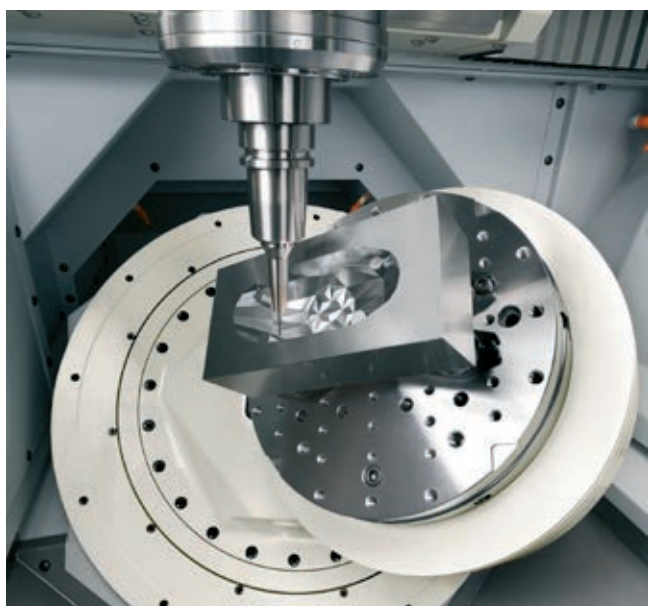
» Toga in dinamična 5-osna miza, podobna priljubljeni zasnovi Makino D800Z
