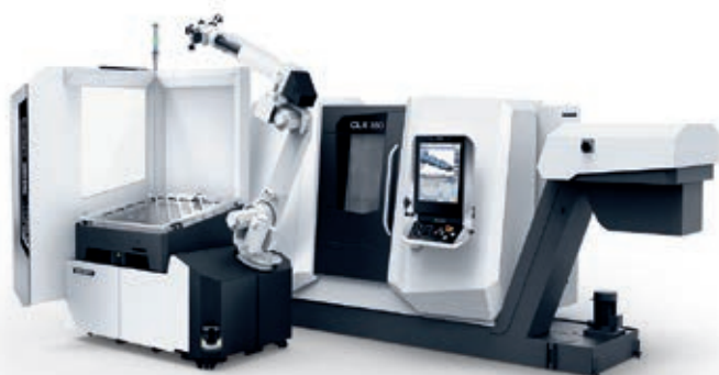
» Univerzalna stružnica CLX 350 proizvajalca DMG MORI avtomatizirana z robotskim sistemom Robo2Go. Vir: DMG MORI
