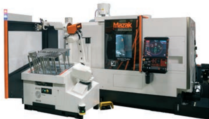
» Na dogodku prikazan center za struženje QUICK TURN 250MY z robotiziranim sistemom za podajanje obdelovancev TA-12/200 izdelan v Združenem kraljestvu.
