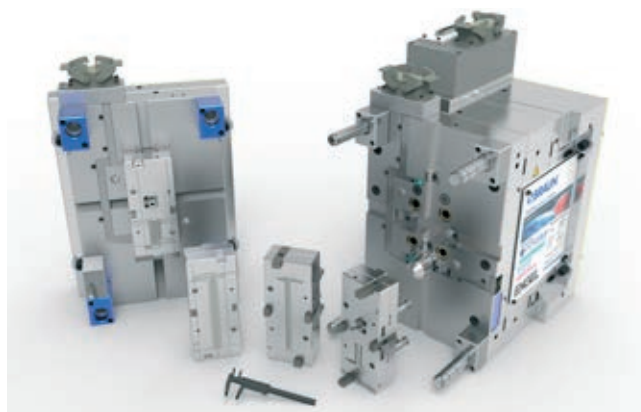
» Popolnoma avtomatizirana rešitev za zelo hitro menjavo vložkov v orodjih – 1 minuta
