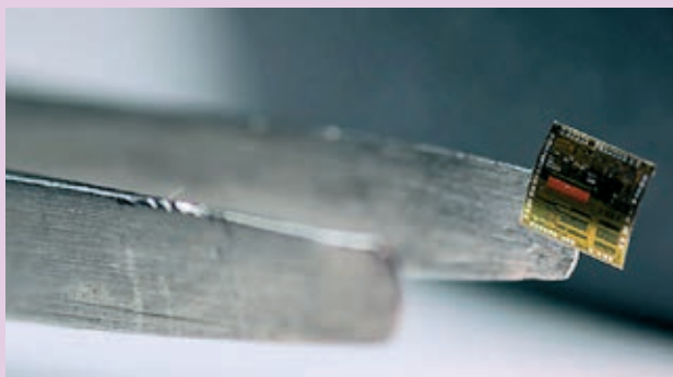
» Kombiniranje industrije silicija in 3D-tiskanja: fleksibilni čip s 7000-krat več spomina kot pri drugih fleksibilnih integriranih vezjih.
