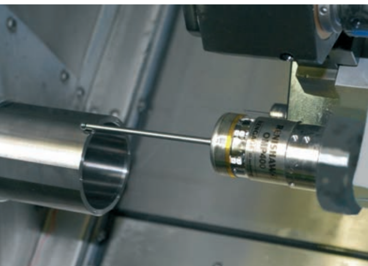
» Merilna glava OMP400 uporablja posebne merilne rutine za merjenje krožnosti in cilindričnosti notranjih in zunanjih površin testnih teles.
