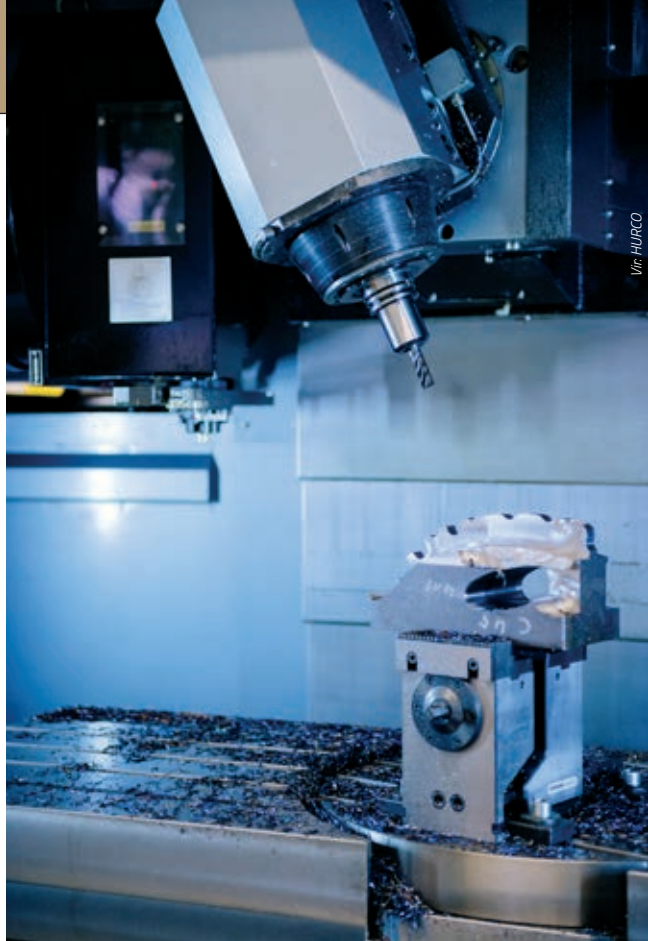
» Obdelava s kombinacijo vrtljive mize in glave obdelovalnega centra serije SRTi proizvajalca HURCO.
