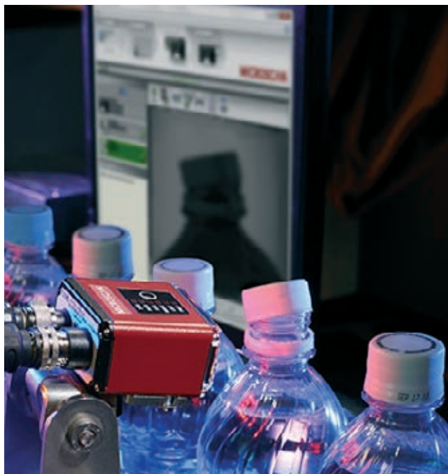
» Končna kontrola v proizvodnji pijač z Omron Microscan rešitvijo strojnega vida
