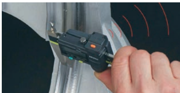
» Novi »U-WAVE fit« sistem za brezžični prenos merilnih podatkov omogoča meritve brez ovirajočih povezovalnih kablov.
