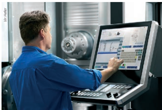
» Hitra in enostavna uporaba dotičnega zaslona pri vnosu nastavitvev za orodje in obdelovanec z modulom »Heller4Operation!«
