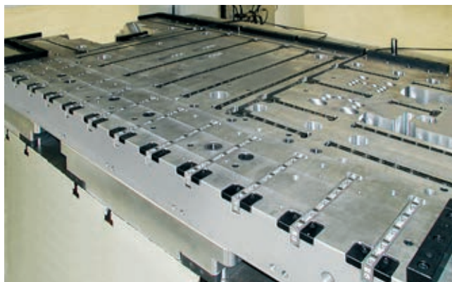
» Slika 1: Na področju tehnike zamenjave orodij podjetje ROEMHELD ponuja nov modularno zgrajen variantni sistem valjčnih in krogličnih letev (Slika: ROEMHELD).
