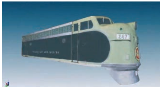
» Slika 4: Visoko natančen oblak točk v realnih barvah je mogoče obdelovati v programski opremi, kot je Geomagic Wrap
