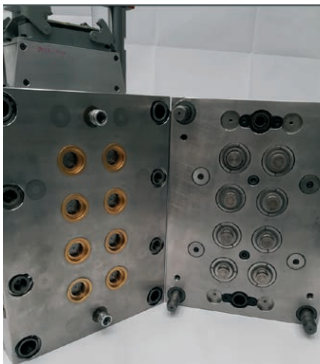
» Slika 12.: Odprto orodje z dvema enotama za okroglo fino centriranje
