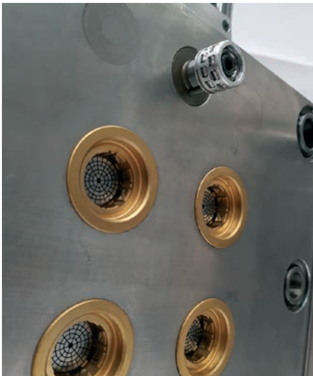
» Slika 13.: Moški del z gibljivimi elementi enote za okroglo fino centriranje
