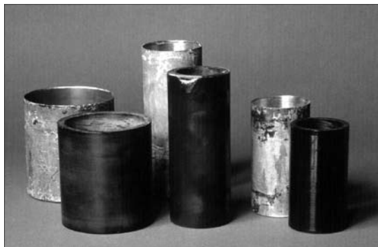
Sl. 11 Tri velikosti galvanskih negativov in odlitkov valjev z njih (Ziegler 2006: 397).
