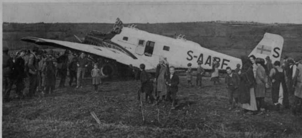
Švedsko vojaško letalo, ki je izgubilo smer ter se je moralo 11. marca pri Cerknici spustiti na tla, odkoder je v par dneh zopet odletelo. Letalo je pravi orjak. S krili vred meri 32 m in je težko 4000 kg. Bencina vzame s seboj 3000 kg. Ima 3 motorje s 1000 konjskimi silami.
