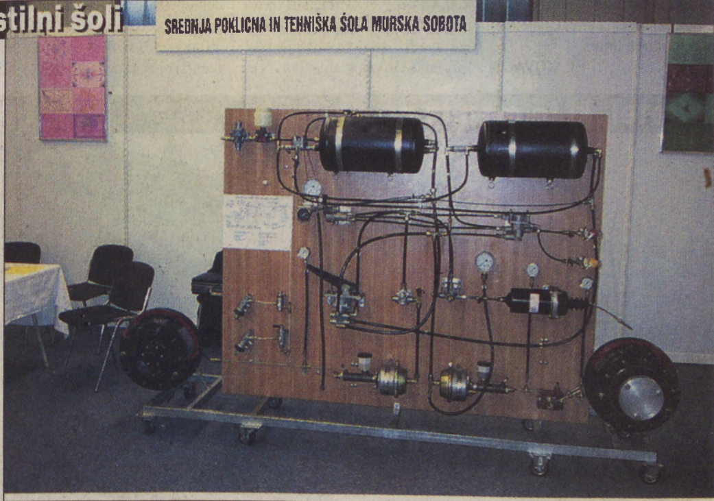
Pnevmatske zavore - učilo, ki so ga skonstruirali pod vodstvom Marjana Česarja.
