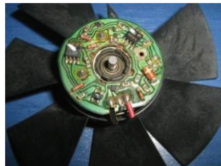
Ventilator poganja koračni motor z vgrajeno krmilno elektroniko, ki v točno določenem zaporedju priklaplja posamezna navitja na napajalni vir.
