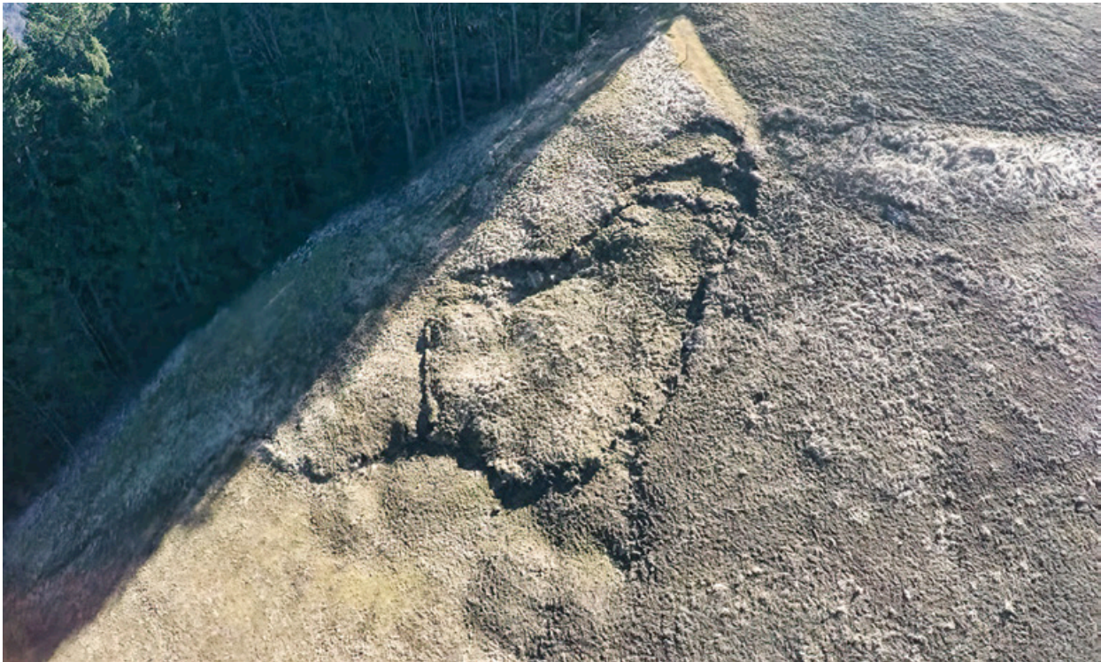
Slika 8: Primer uporabe brezpilotnega zrakoplova pri opazovanju obsega in gibanja zemeljskega plazu Smrečnikovo v Mežici (foto: D. Mori) Figure 8: An example of the use of an UAV to observe the extent and movement of the Smrečnikovo landslide in Mežica (Photo: D. Mori)
