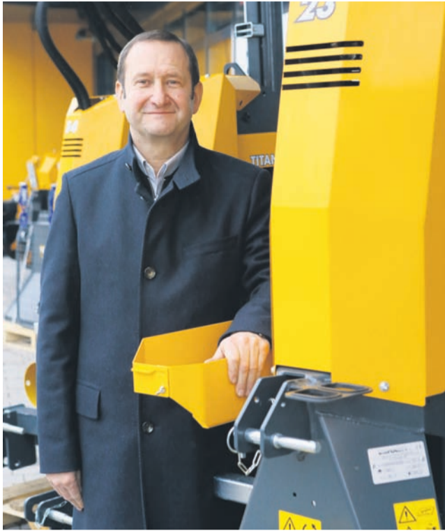
Cepilniki z udarno močjo od 11 do 26 ton, imajo serijsko vgrajeno pobiralko za dvigovanje ceplencev in ročico za njihovo pridrzanje, kar omogoča varno in natančno cepljenje. Domišljeno oblikovanje uporabniku ponuja tudi površino za odlaganje dodatne opreme. Cepilnike poganja bencinski pogon ali elektromotor ali kombinacija obojega.
