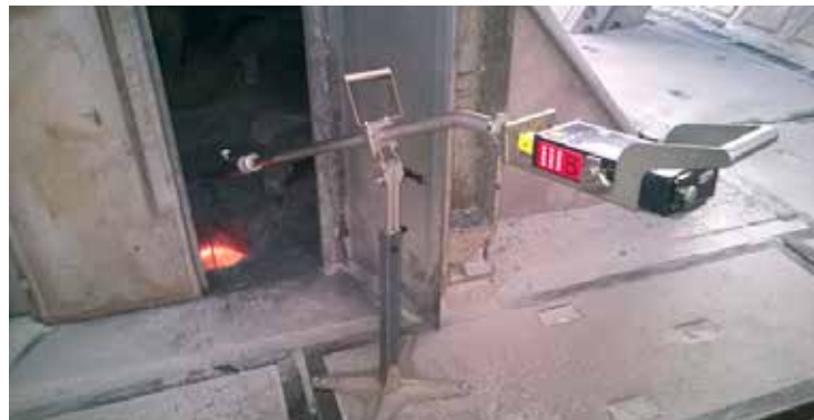
In situ meritev STARprobe v elektrolizi
