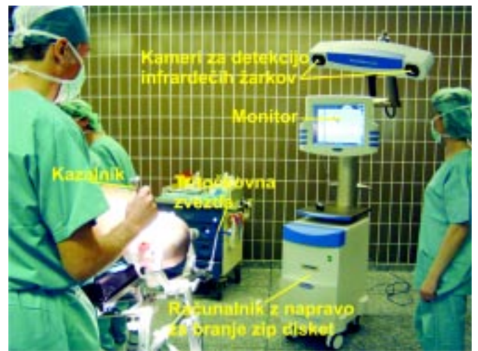
Sl. 2. Prikaz posameznih komponent nevronavigacijskega sistema med njegovim umerjanjem.
