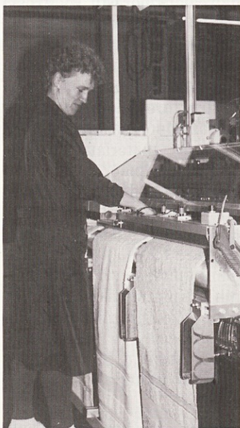
Franka na najnovejšem šivalnem avtomatu D 600 pri vpeljevanju brisač za striženje
