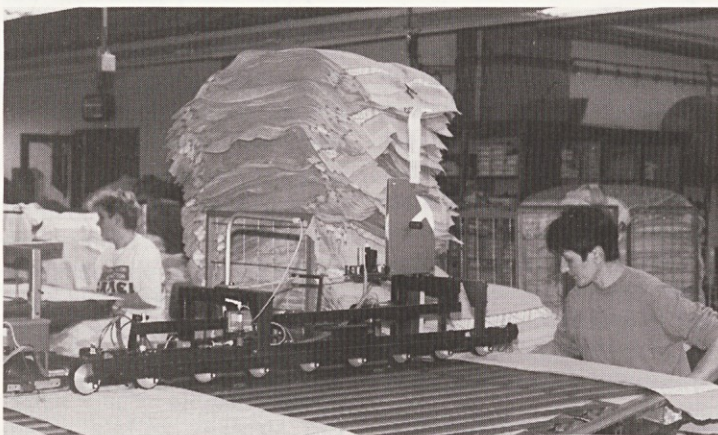
Franka na najnovejšem šivalnem avtomatu D 600 pri vpeljevanju brisač za striženje
