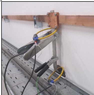
Slika 5. Priključitev na Rf trak
