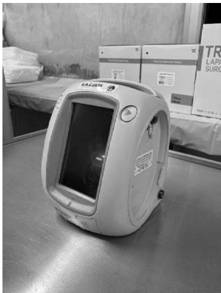
Slika 5: Enota vakuumske črpalke
