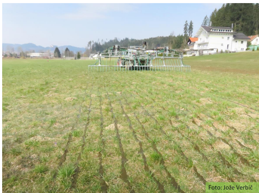
Slika 6: Na travinju je najenostavnejša izvedba gnojenja z vlečenimi cevmi, ki se deloma prilagajajo reliefu. Pri gnojenju z vlečenimi cevmi se površina gnojevke, ki je izpostavljena izhlapevanju amonijaka, v primerjavi z gnojenjem z razpršilno ploščo, zmanjša za 80 do 90 %.
