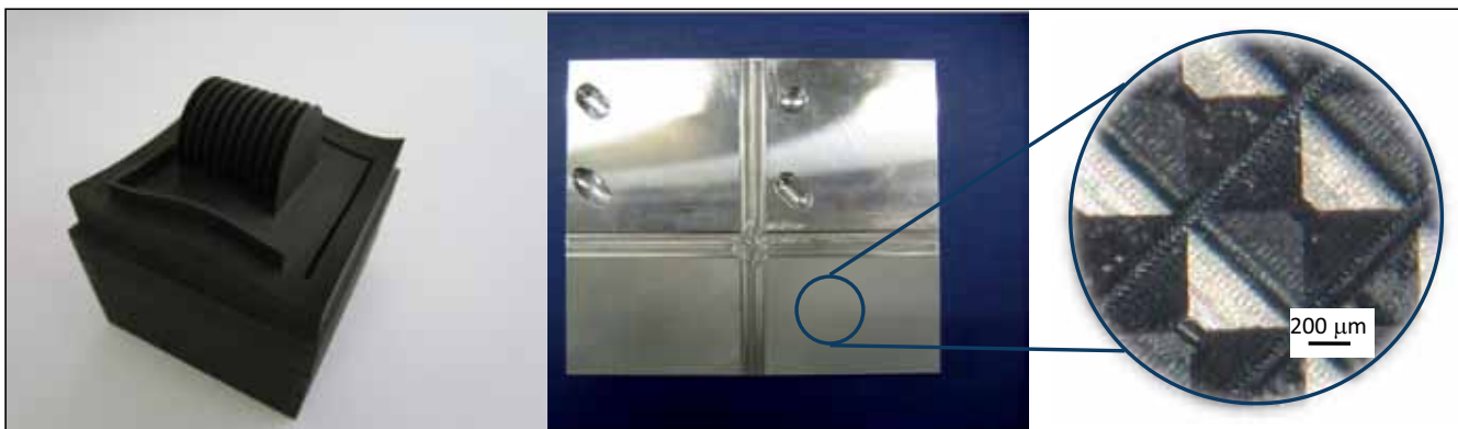
Slika 9. Visokohitrostna precizna obdelava: grafitna elektroda za EDM s tankimi rebri (levo) in bakrena pečatna plošča za blisterje
