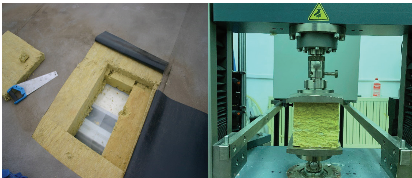
Slika 1 • Vzorec mineralne volne iz ravnih neprezračevanih streh (a) in testiranje trdnostnih lastnosti z uporabo univerzalnega preskusnega stroja Zwick/Roell 2010 (b).
