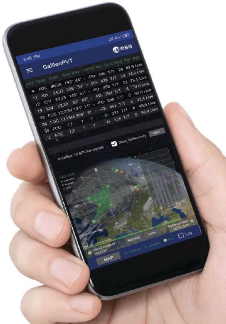
Slika 1: Vgrajeni dvofrekvenčni GNSS-sprejemniki in hkratna zmožnost obdelave surovih GNSS-meritev na pametnih telefonih z operacijskim sistemom Android že omogočajo podmetrsko točnost določitve položaja (Crosta in sod., 2019).
