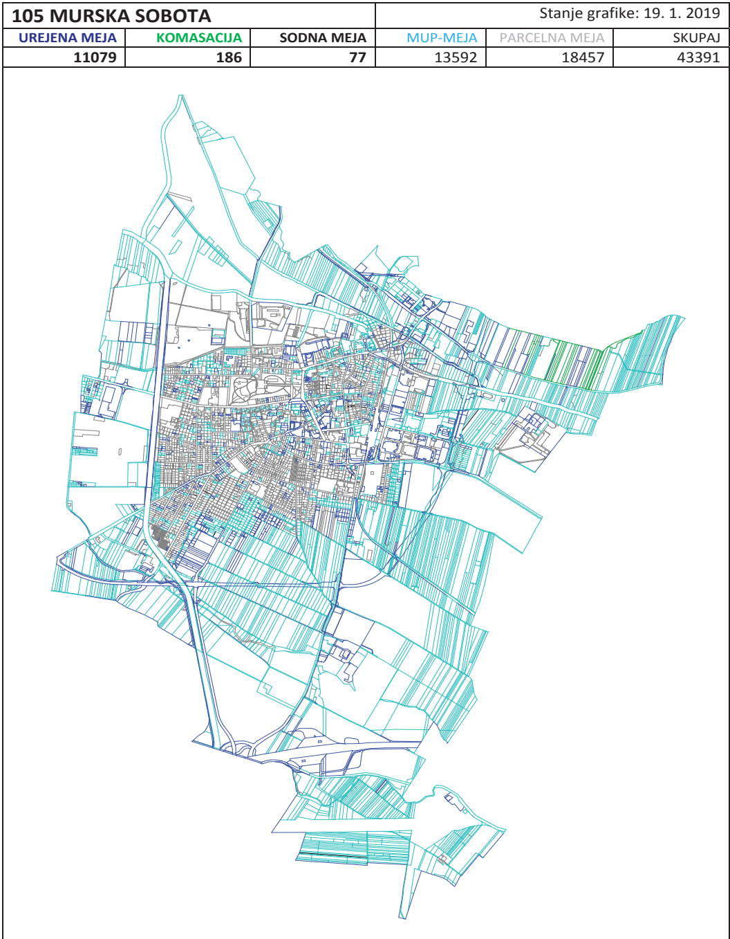
Slika 6: Primer kombinacije več vrst izmer v k. o. 105 Murska Sobota. Leta 1967 je bila izvedena nova izmera območja naselja (sivo). Sredi 70. let je bila izvedena nova izmera preostalega dela k. o. (svetlo modro). Manjši del k. o. je bil vključen v komasacijo (zeleno, odebeljeno). Urejene meje iz geodetskih postopkov po letu 2000 so vidne v odebeljeni temno-modri barvi. Vir: OGU Murska Sobota, 2019.
