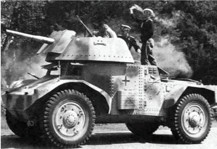
Nemška predelava z na vrhu odprto kupolo in nemškim protitankovskim topom
