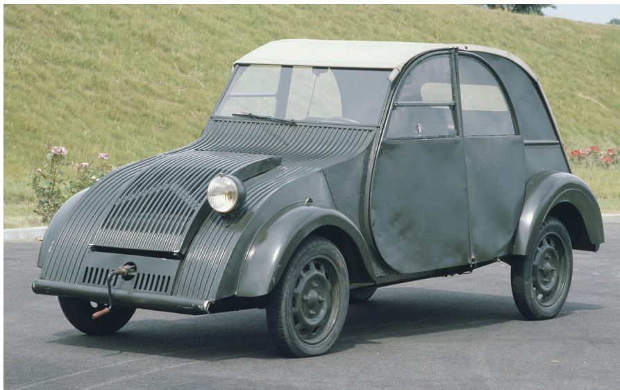
Predvojni Citroënov prototip TPV, predhodnik 2CV, je imel samo en žaromet in ročico za ročni zagon motorja. S slednjo so bile opremljene tudi sodobnejši nasledniki tega vozila.
